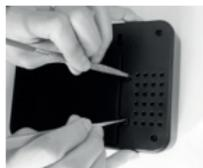
1) Abra la tapa de la carcasa de la batería presionando y tirando las dos hebillas con las herramientas.
