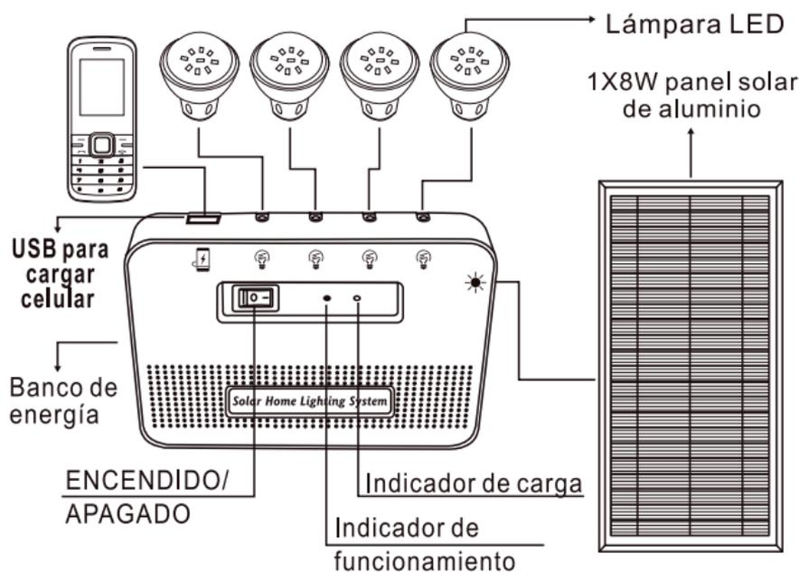
El Sistema Solar **Olympic** es un dispositivo portátil ideal para la iluminación casera y la carga del teléfono celular para áreas donde no se posee electricidad.
